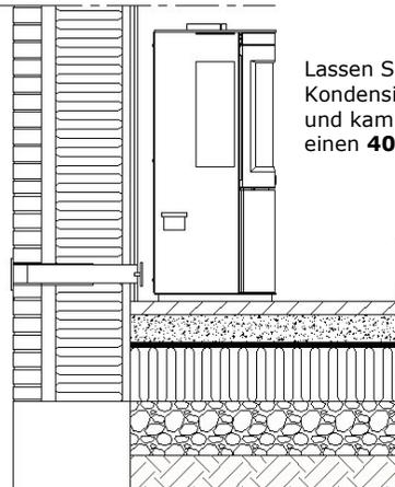
Lassen Sie zwischen Kondensisolierung und kaminboden einen **40 mm** Spalt
