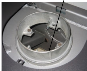
Markierung für den Kondensatablauf.
